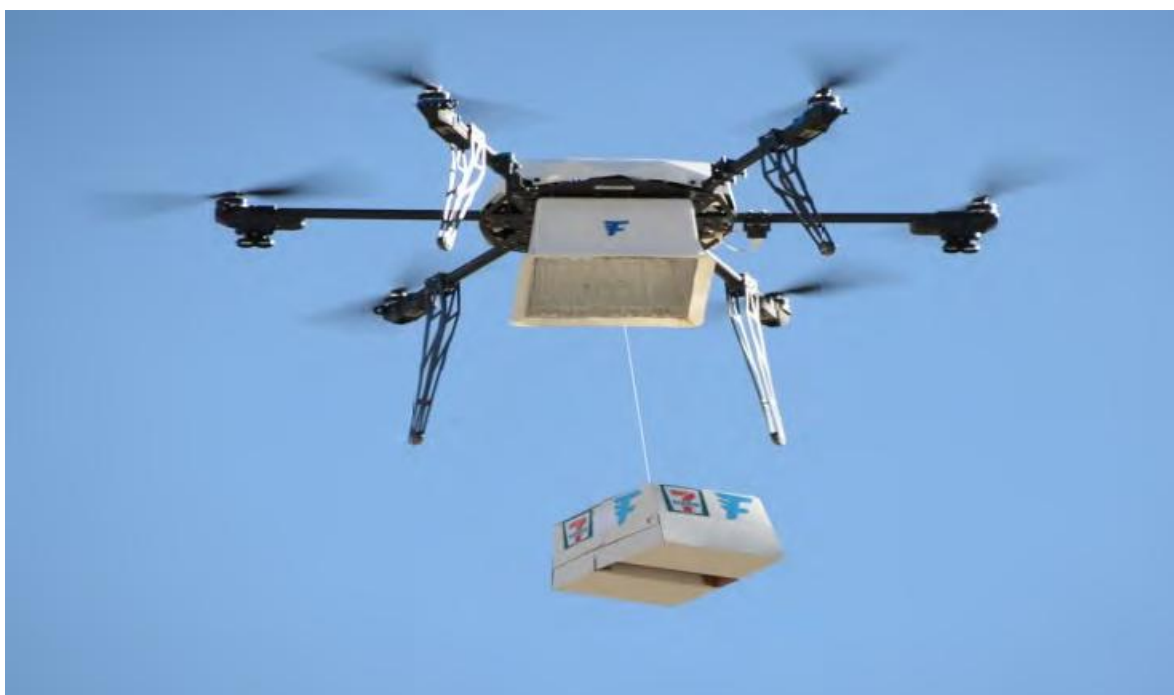
Приклад гексакоптера класу «mini» із зовнішньо підвішеним вантажем
